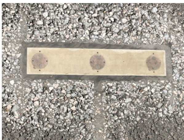
Рис. 3. Датчик BOSO II в покрытии
