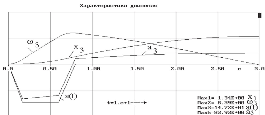
Рис. 3. Изменение параметров системы при столкновении автобуса
