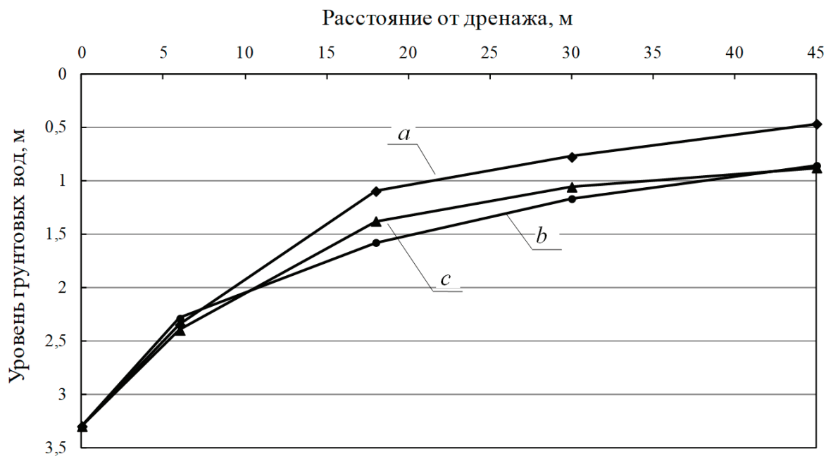
Рис. 1. Кривые депрессии для створа № 2: a — по данным мониторинга, b — численное моделирование, c — аналитический расчет
