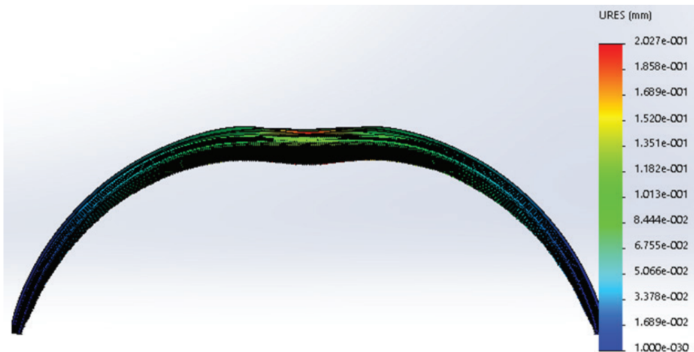
Рис. 8. Деформации при гравитационной нагрузке на арку пролетом 9.4м t=0,8 мм
