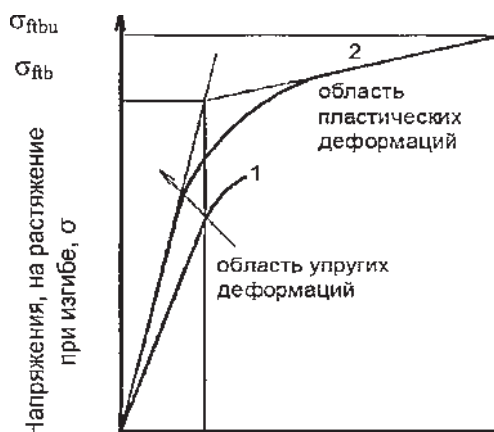
Рис. 2. Кривые «напряжение-деформация» при испытании на растяжение при изгибе: 1 — неармированный бетон; 2 — сталефибробетон
