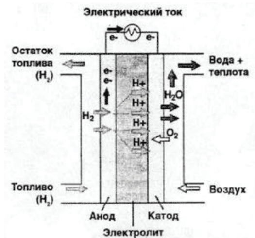
Рис. 1. Топливный элемент с протонообменной мембраной
