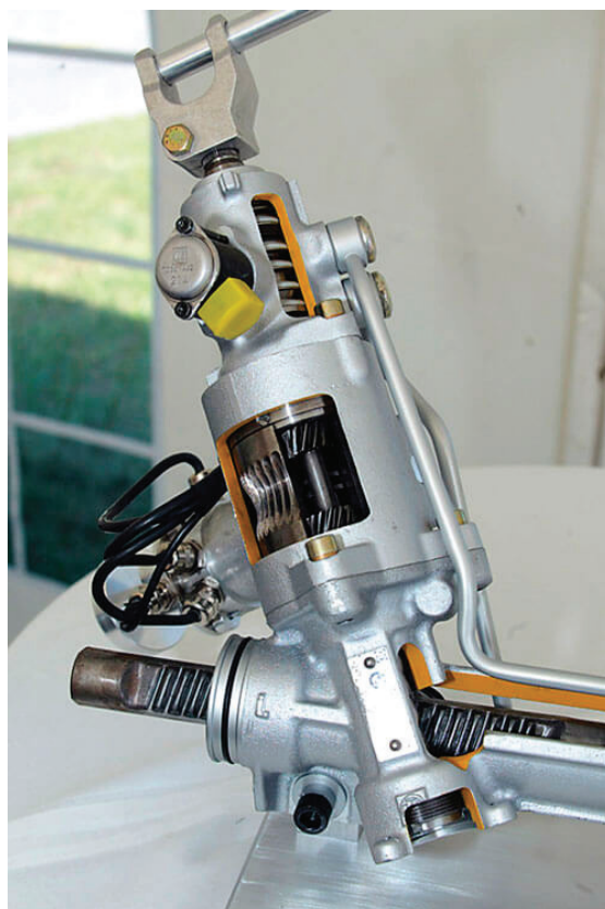
Рис. 1. Разрез рулевого вала с планетарным редуктором система активного рулевого управления AFS
