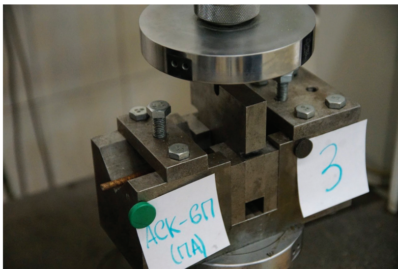
Рис. 7. Образец в испытательной машине перед испытанием на поперечный срез
