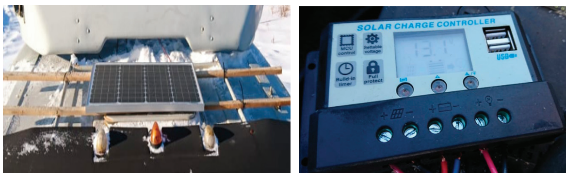
Рис. 4. Используемые в исследованиях солнечная батарея и регулятор заряда от солнечной батареи
