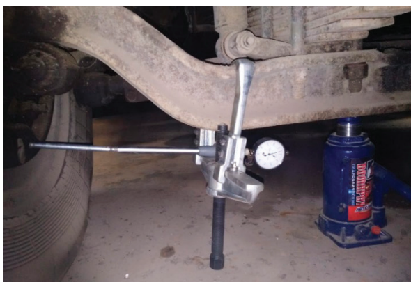
Рис. 7. Определение люфта в шкворнях автосамосвала
