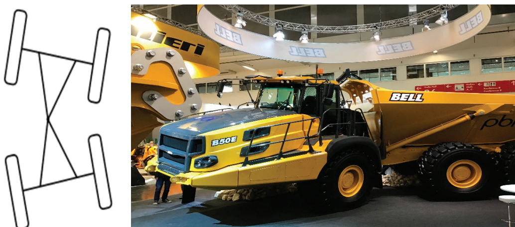
Рис. 6: Поворот шарнирно сочлененными рамами самосвала Bell B50E
