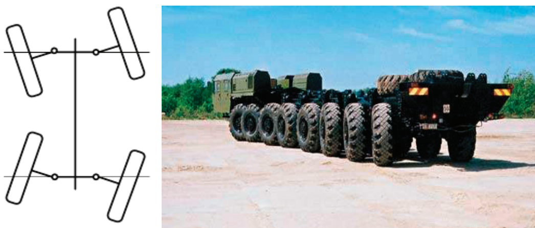
Рис. 3: Поворот передних и задних управляемых колес МЗКТ-79221
