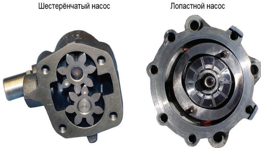
Рис. 2. Шестерёнчатый и лопастной насос
