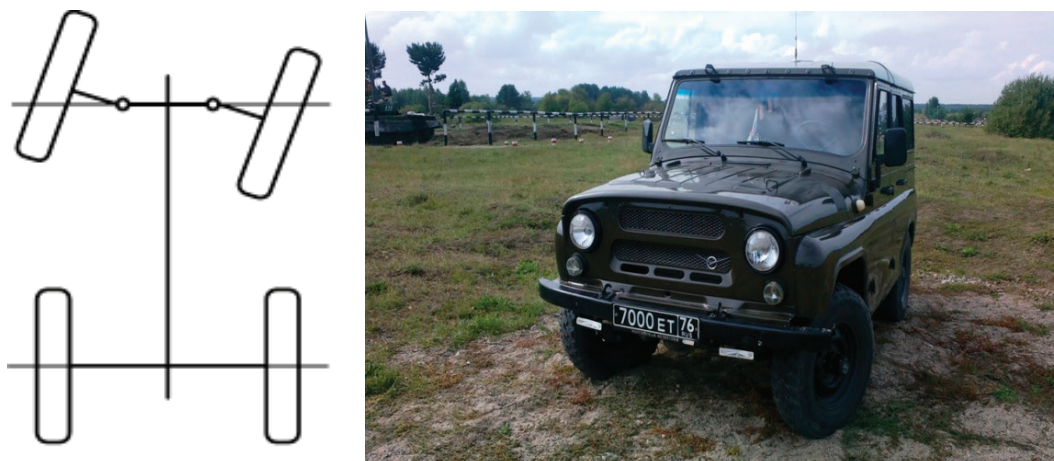
Рис. 2: Поворот колесами передней оси УАЗ-31514
