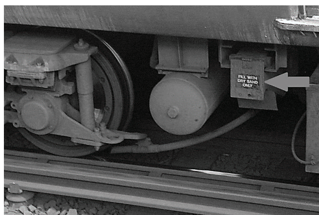
Рис. 5. Устройство для подачи песка к колёсам железнодорожного вагона
