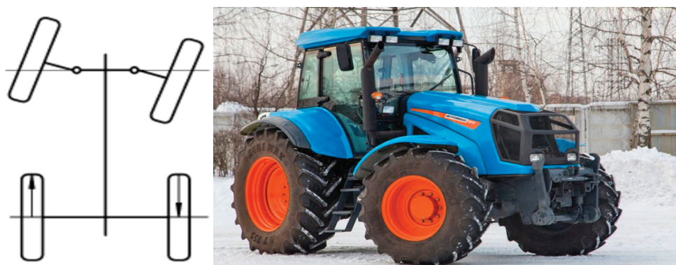
Рис. 5: Комбинированный поворот трактора АГРОМАШ 180ТК — ТК-3–180Д
