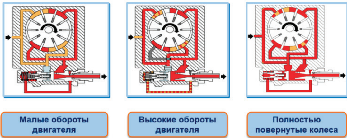
Рис. 3. Схема и принцип работы лопастного насоса гидроусилителя
