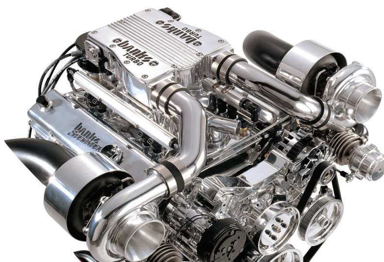
Рис. 3. Двигатель внутреннего сгорания с системой двойного турбонадува
