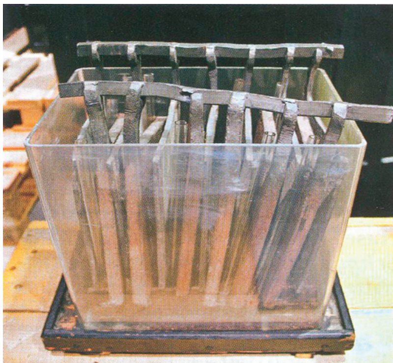
Рис. 2. Аккумулятор Иоганна Вильгельма Риттера
