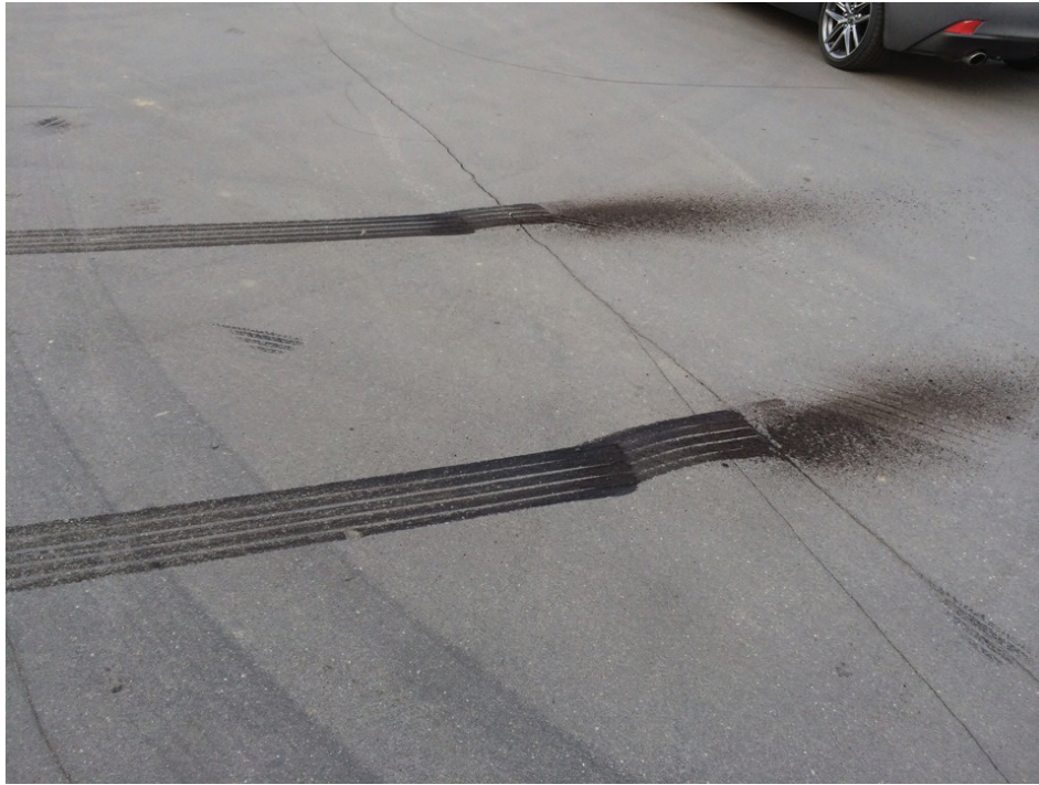
Рис. 1. Следы, оставленные автомобилем, не оснащенным ABS
