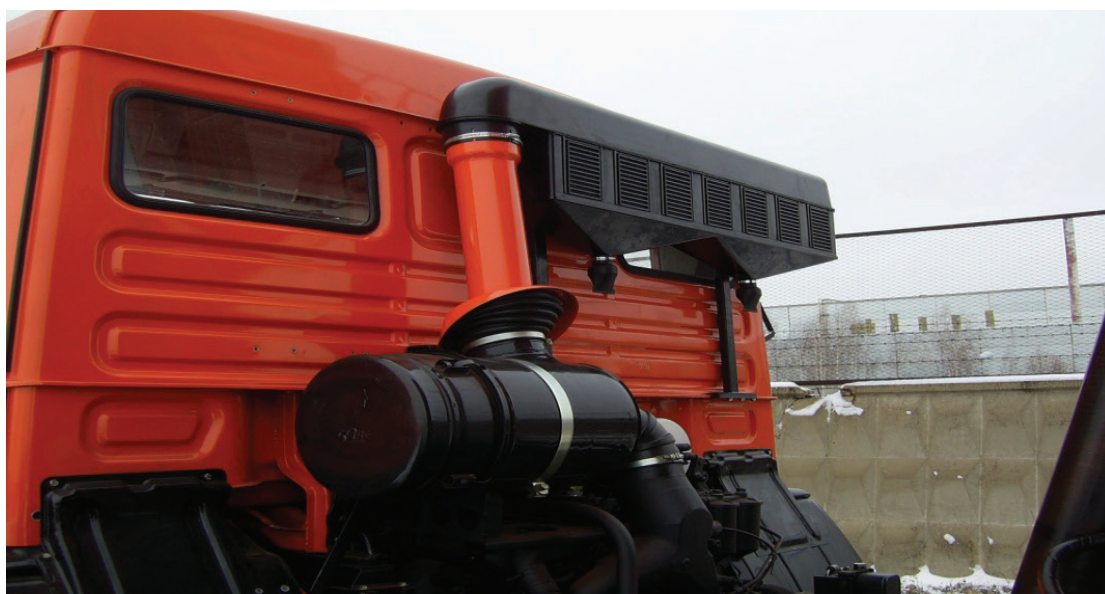
Рис. 2. Воздухоочиститель, поглощающий шум
