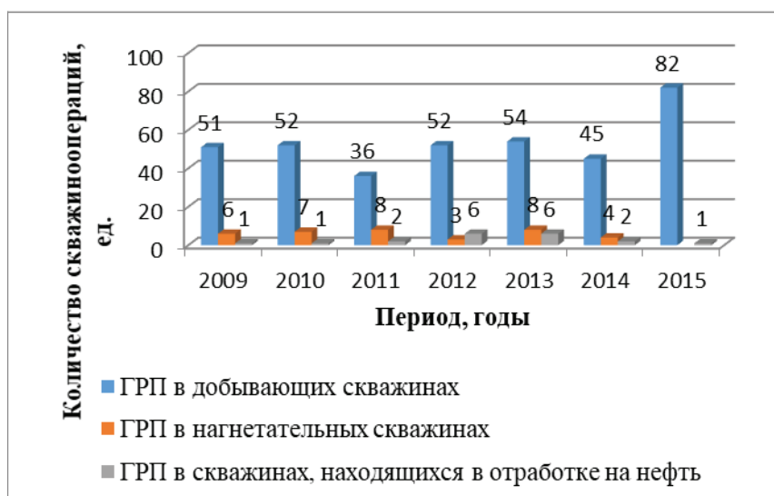
Рис. 2. Динамика проведения ГРП в добывающих, нагнетательных и скважинах, находившихся в отработке на нефть месторождения X
