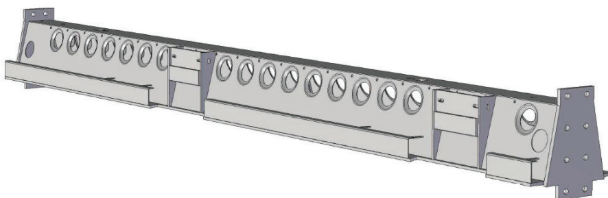
Рис. 4. Концевые пластины крепления балок к колоннам
