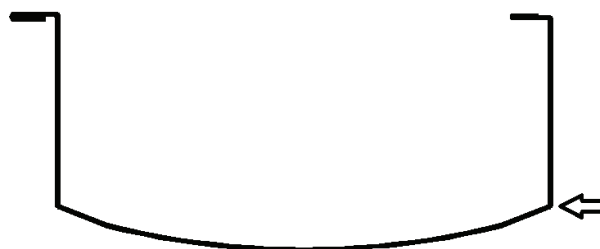
Рис. 1. Сечения/расчетная схема для определения предельно допустимых нагрузок на свод
