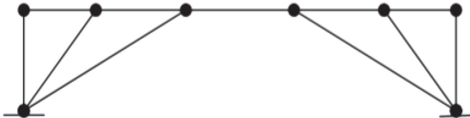
Рис. 4. Подкосная система с четырьмя подкосами
