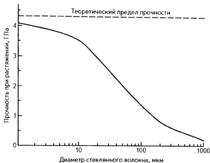
Рис. 1. Зависимость прочности при растяжении от диаметра стеклянных волокон
