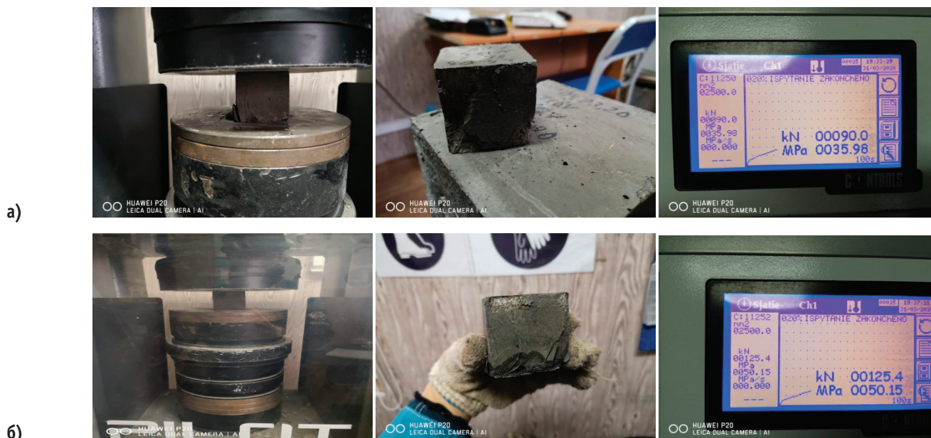
Рис. 2. Сжатие на прочность а) 7 суточных образцов и б) 28 суточных образцов бетона марки G1
