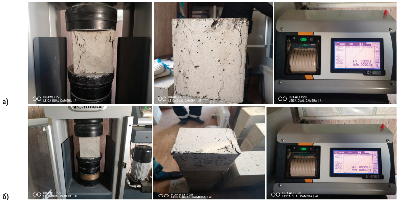
Рис. 1. Сжатие на прочность а) 7 суточных образцов и б) 28 суточных образцов бетона класса В35
