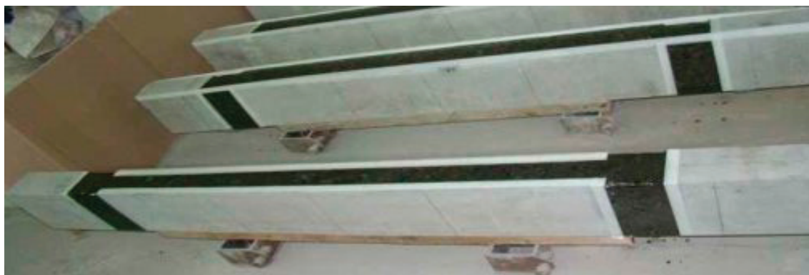
Рис. 1. Усиление деревянной балки углеродным волокном [9]
