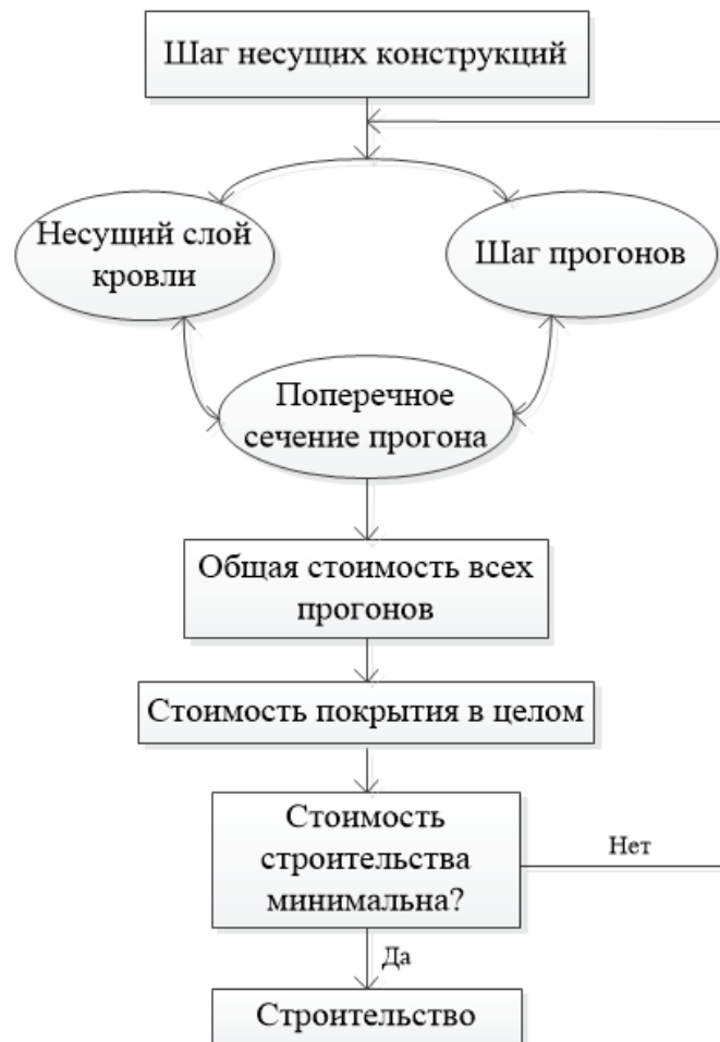
Рис. 1. Схема последовательности расчета покрытия
