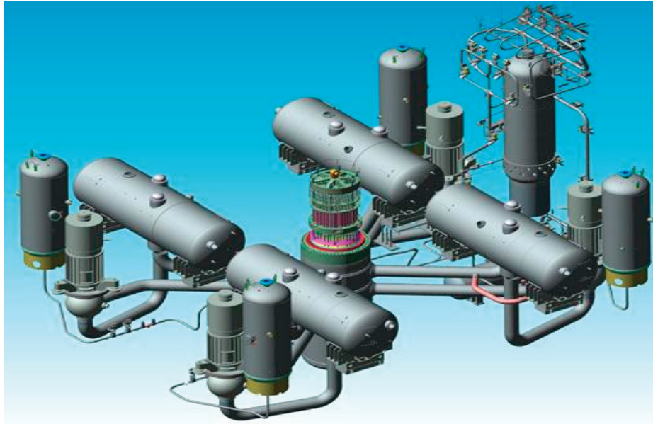
Рис. 1. Общая компоновка ЯЭУ ВВЭР-1000
