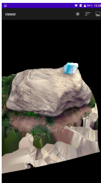
Рис. 6. Полученная модель после четвертого эксперимента с применением фильтрации шумов и Poisson реконструкции
