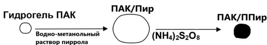
Рис. 1. Схема синтеза гидрогеля композитов ПАК/ППир
