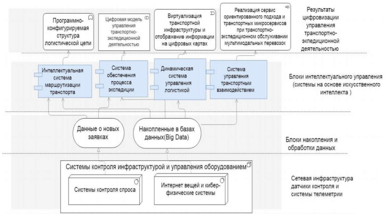
Рис. 6. Схема цифрового управления на основе нейросетевых технологий
