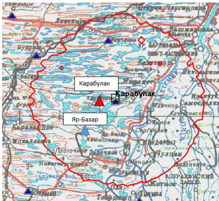
Рис. 2. Зона покрытия, рассчитанная в «ПИАР» для РТС Карабулак
