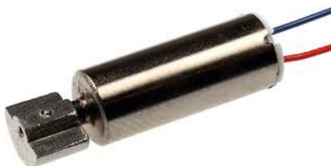
Рис. 3. Смещенный центр тяжести у вибромоторчика
