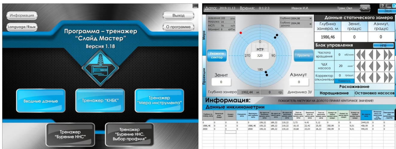
Рис. 1. Человеко-машинный интерфейс диалоговых окон тренажера: настройки параметров тренировки (слева), имитации процесса бурения направленной скважины (справа)
