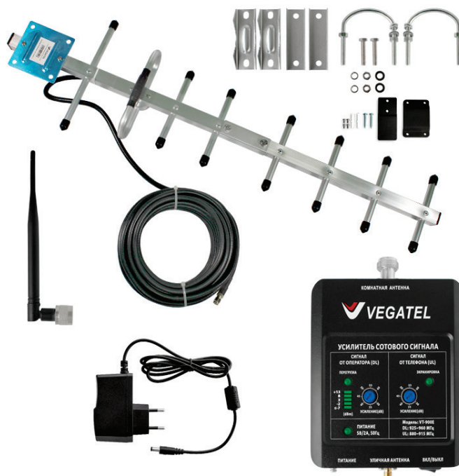
Рис. 1. Комплект VEGATEL VT-900E-KIT LED2017 решающий проблему плохой связи
