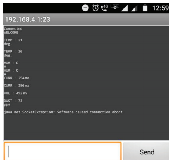
Рис. 2. Приложение на смартфоне которое может принимать данные о текущем состоянии солнечной батареи (TEMP — означает показания температуры, VOL — текущее напряжение, CURR — текущая сила тока)
