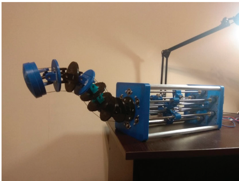
Рис. 3. Манипулятор на гибких связях
