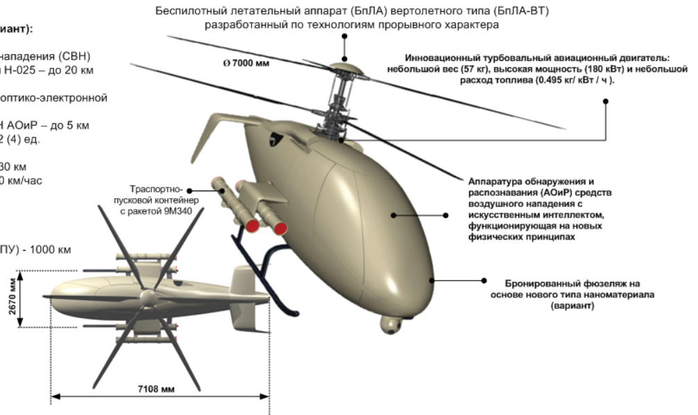
Рис. 3. Беспилотный летательный аппарат вертолетного типа
