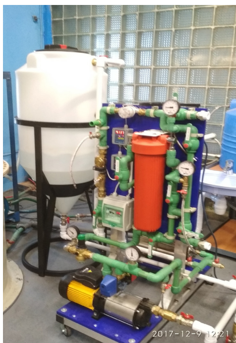
Рис. 3. Установка фильтрования для определения эффективности работы фильтра «Геракл» на примере эмульсии масла в воде
