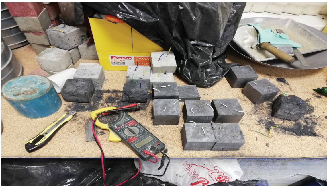
Рис. 2. Процесс измерения электропроводности образцов кубиков
