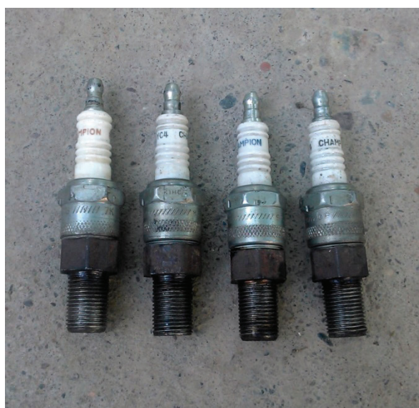
3-расм. Таклиф этилаётган свеча ва тагликларнинг йиғилган кўриниши
