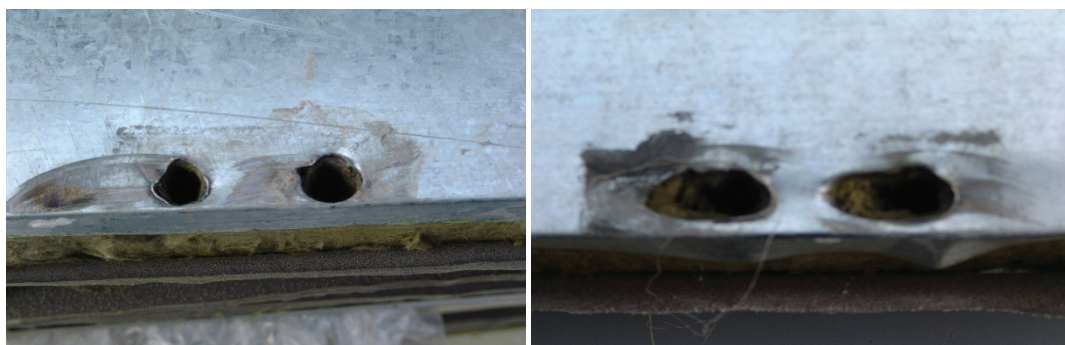
Рис. 5. Податливость крепления шпильки с сэндвич панели
