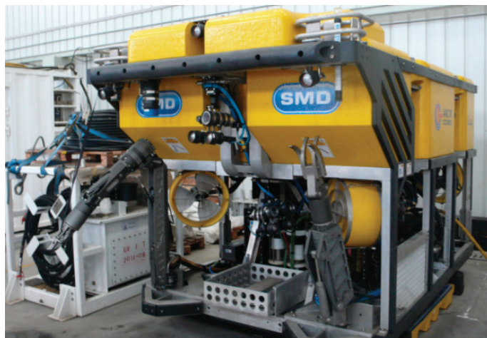
Рис. 2. Многофункциональная машина для ремонта глубоководных нефтепроводов ROV
