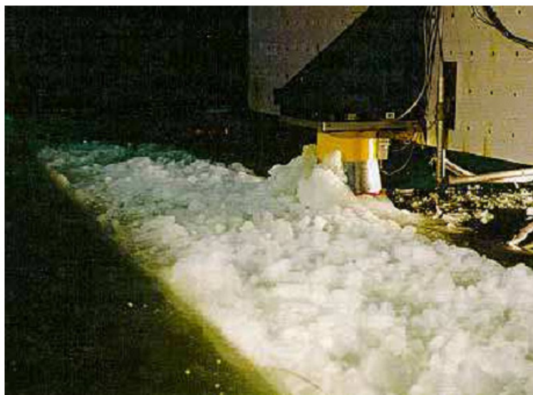
Рис. 19. Фотография, показывающая модельное испытание взаимодействия однолетнего тороса с опорой моста Конфедерации [28]
