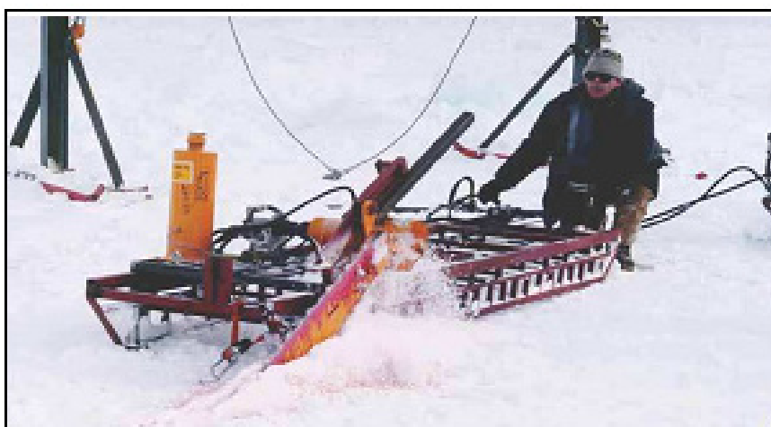
Рис. 12. Большая пила, разработанная для резки сквозного слоя на шельфе Сахалина [23]
