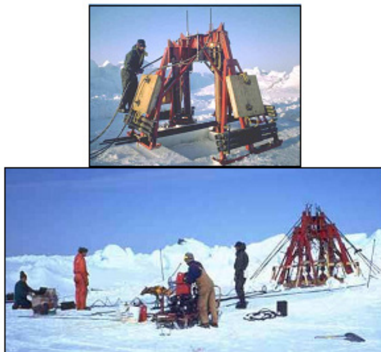
Рис. 15. Оборудование, использованное для ударного испытания на сдвиг в России, 1998 [29]
