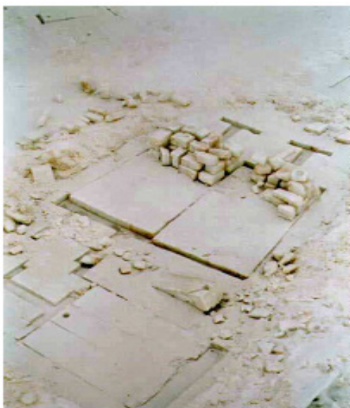
Рис. 11. Фото ледяных щелей, разрезанных на консолидированном слое для выполнения прямого испытания на сдвиг [29]
