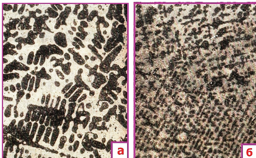
Рис. 2. Микроструктуры наплавочных сплавов различных систем легирования ( \times 550 ): а) Fe–C–Cr–W; б) Fe–C–Cr–W–B.
