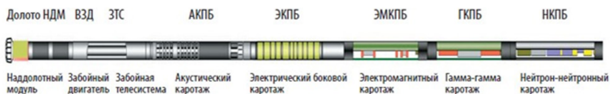
Рис. 1. Пример компоновки СКПБ с телесистемой ЗТС-42-ЭМ-М
