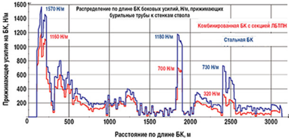
Рис. 2. Сравнительные результаты расчетов по распределению удельных боковых усилий действующих на БК
