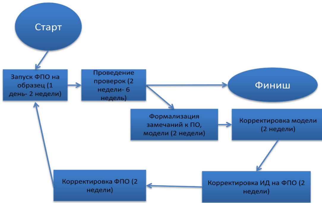
Рис. 3. Типовой процесс отработки ПО на аппаратуре
