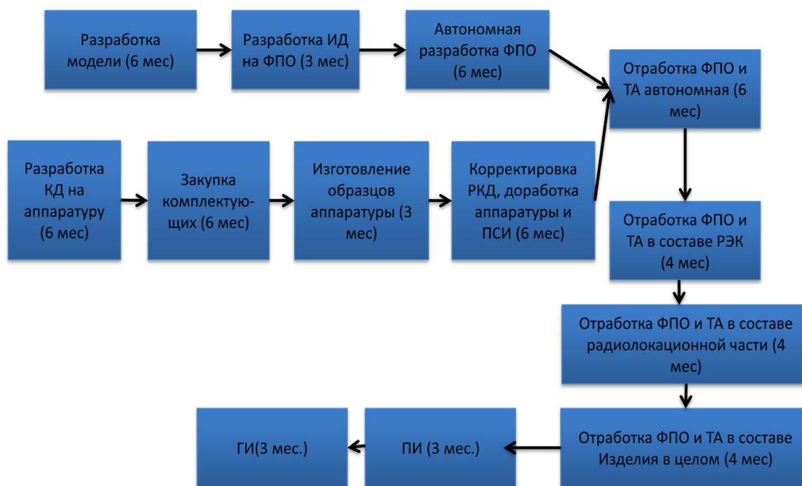
Рис. 2. Структурная схема процесса разработки приемной системы
