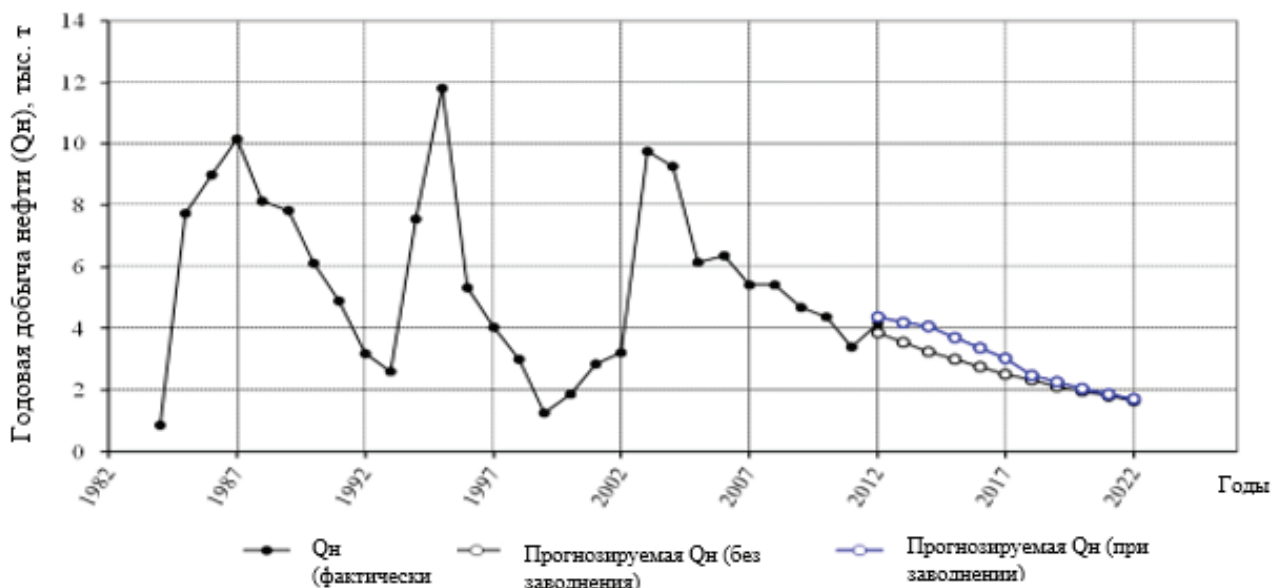
Рис. 3. Горизонт СП V блока. Динамика добычи нефти с применением процесса закачки воды
