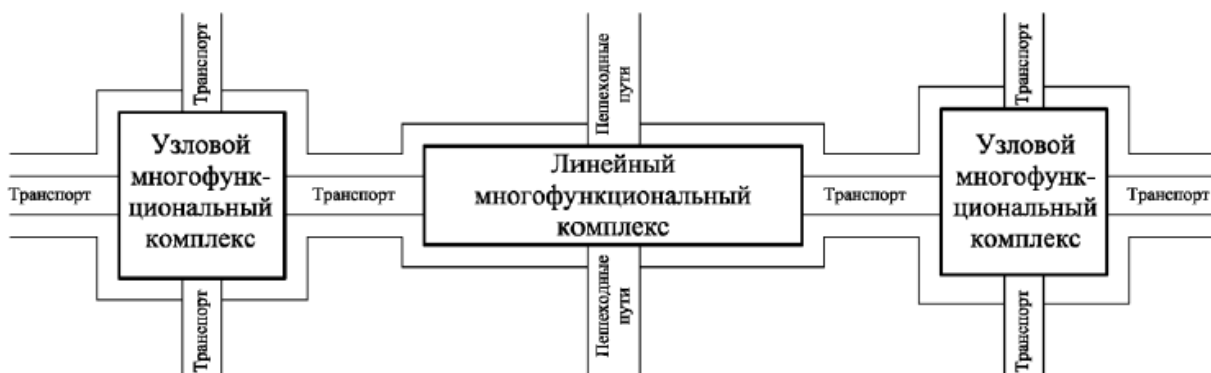
Рис. 2. Схема организации структурных элементов УДС в составе многофункционального транспортного комплекса
