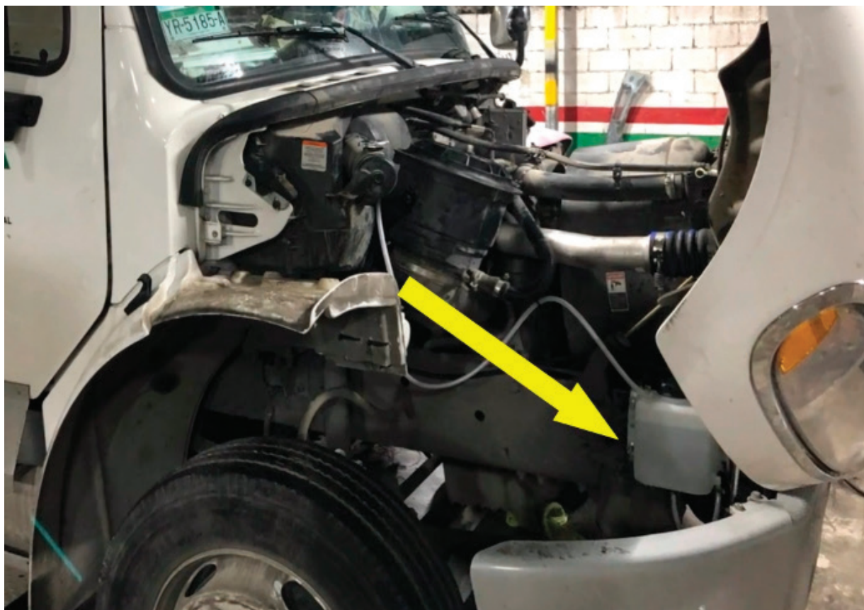
Рис. 3. Расположение бака с дистиллированной водой в подкапотном пространстве
