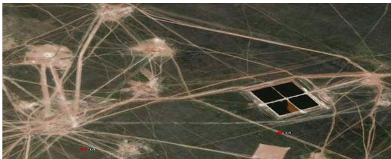
Сурет 1. Мұнай ұңғымаларын бұрғылау кезінде Жаңажол кенорнының аумағының топырағының механикалық зақымдануы
