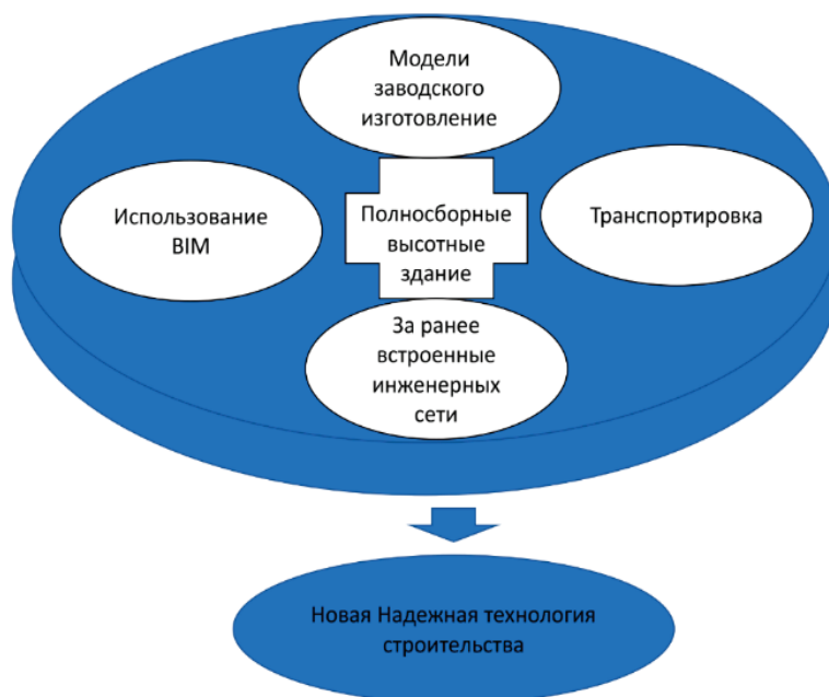
Рис. 1. Концептуальный взгляд на строительство полноборных высотных зданий
