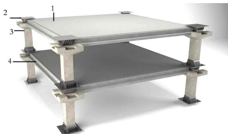
Рис. 3. Общий вид типового строительного модуля в собранном виде. 1 — пол; 2 — узел соединения колонн; 3 — сталежелезобетонная колонна; 4 — сталежелезобетонный ригель
