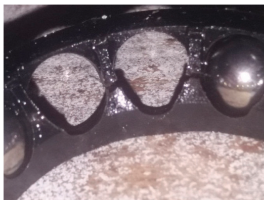
Рис. 4. Трещины перегородок сепаратора подшипника
