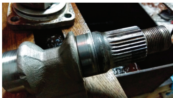
Рис. 3. Вал-сектор со следами износа
