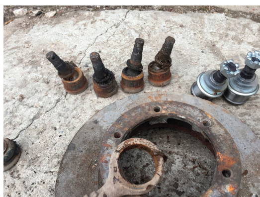
Рис. 7. Изношенные рулевые наконечники
