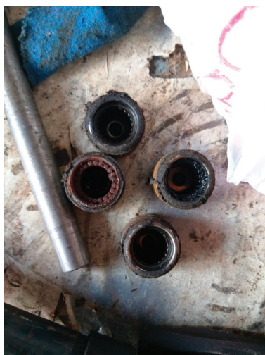
Рис. 2. Игольчатые подшипники крестовины, подвергшиеся коррозии и разрушению
