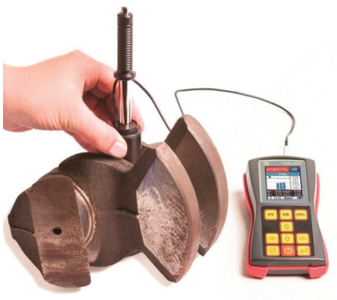
Рис. 5. Контроль твердости в пазу детали динамическим датчиком
