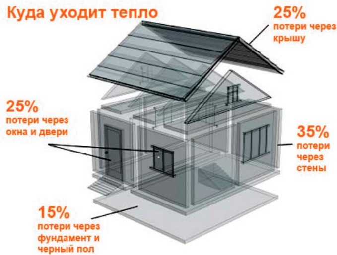
Рис. 1. Потери тепла через отдельные элементы здания
