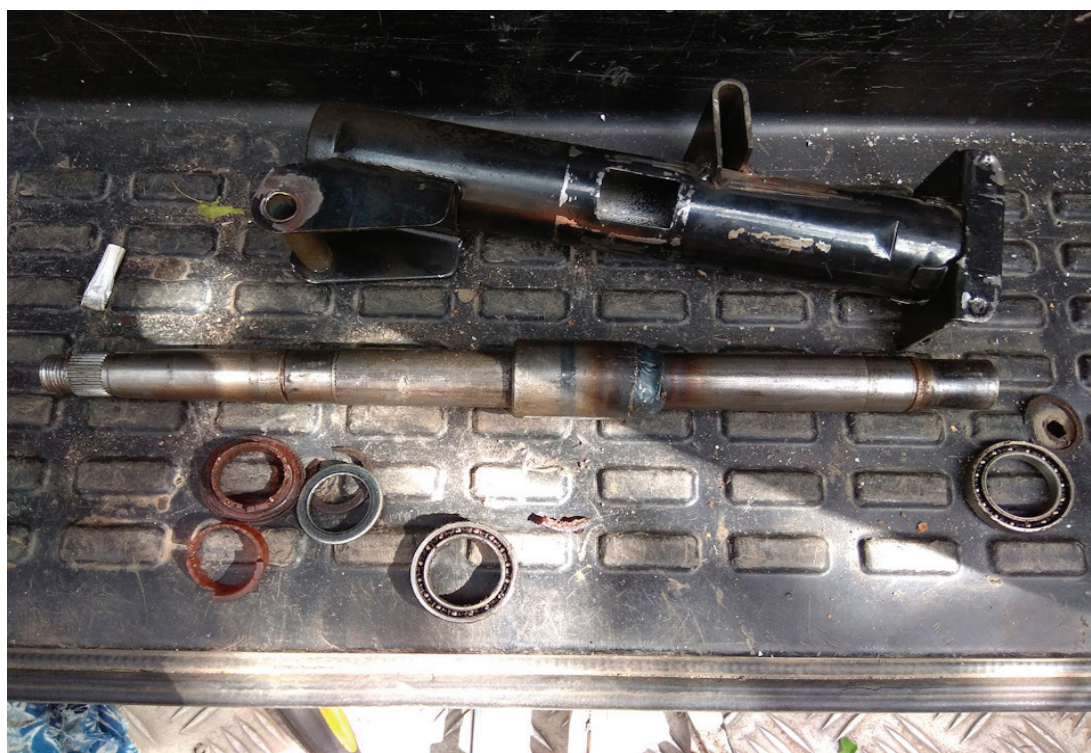
Рис. 1. Изношенные втулки подшипника рулевой колонки
