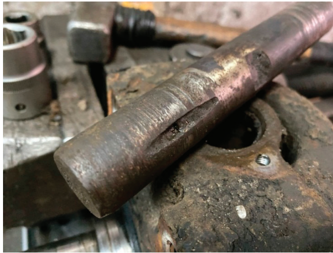
Рис. 8. Шкворень со следами износа
