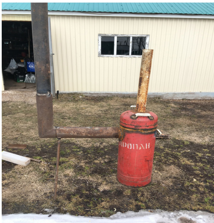
Рис. 6. Готовый котел без водяной рубашки
