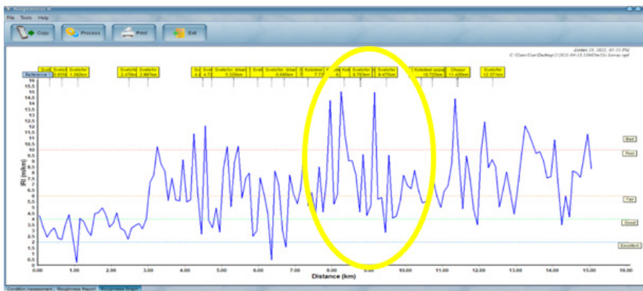
3-расм. Roughometer III қурилмаси ёрдамида «Шота Руставели» кўчасида олинган саноқлар шаҳар йўлининг қопламаси раванлиги ҳолатининг графиги
