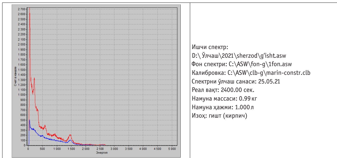
Расм. 4. Гишдан тайёрланган ўлчаш намунаси учун сцинтилляцион спектр
