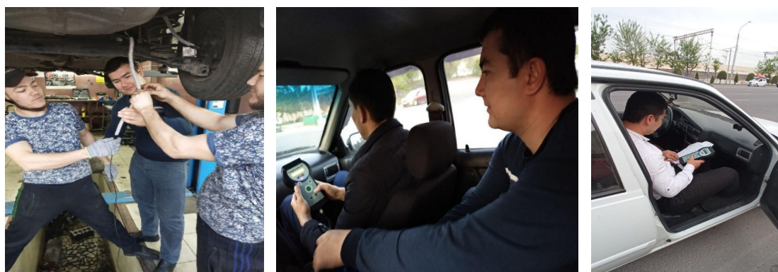
6-расм. Roughometer III қурилмасини Nexia 2 автомобилига ўрнатиш ва саноқ олиш жараёnlари
