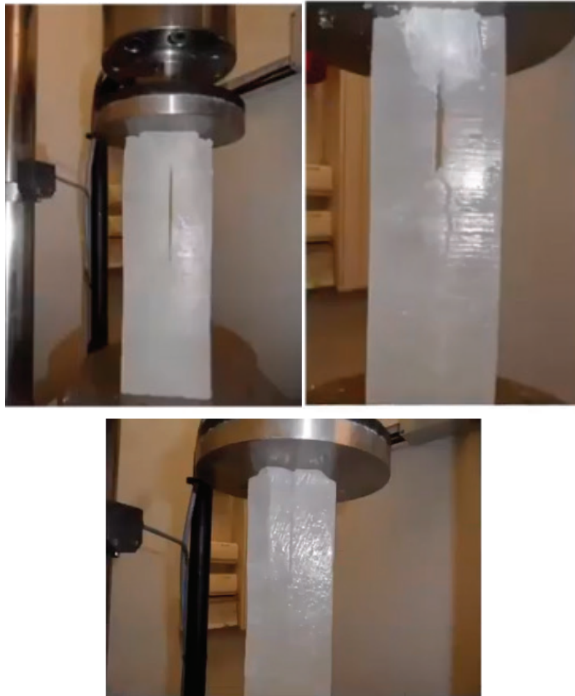
Рис. 7. Экспериментальное сжатие ледяных кернов
