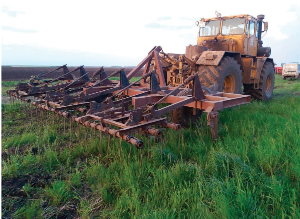
Рис. 2. Экспериментальный машинно-тракторный посевной агрегат
