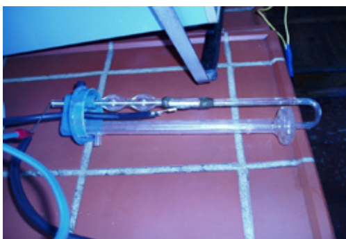
Рис. 2. Усовершенствованный вискозиметр Пинкевича (ВПЖ-4)
