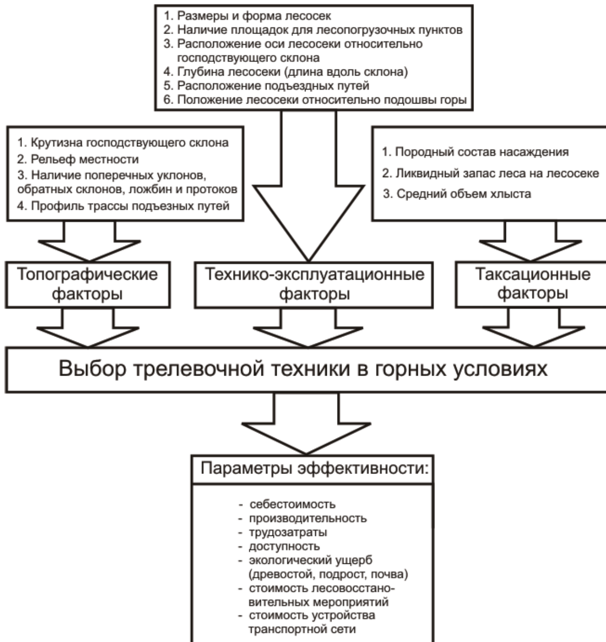
Рис. 2. Схема к определению выбора лесосечного транспорта в условиях горных лесозаготовок
