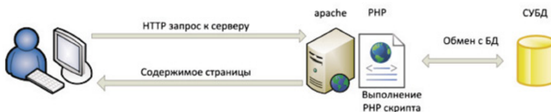
Рис. 1. Схема работы предлагаемого WEB-приложения
