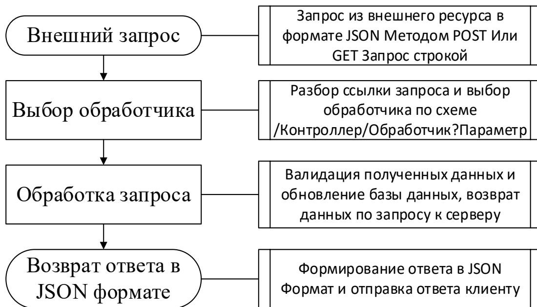
Рис. 1. Схема работы RESTful API сервера
