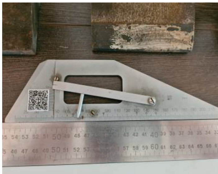
Рис. 6. Нанесение QR-кода на измерительный инструмент
