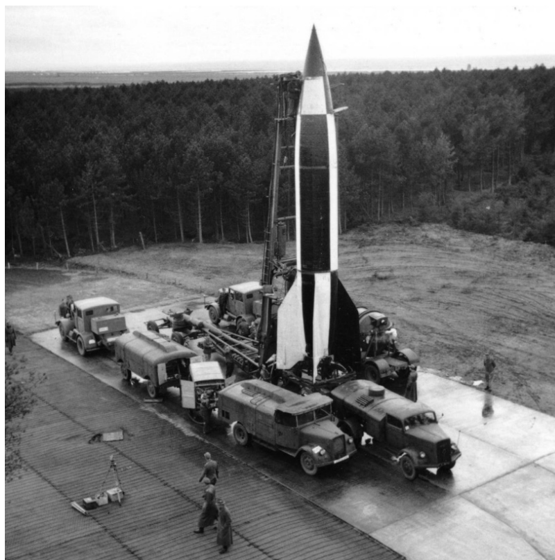
Рис. 1. Заправка горючим ракеты Фау-2 на стартовой площадке [7]
