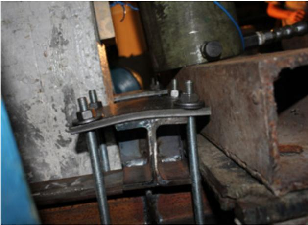
Рис. 4. Погиби опорных пластин и болтов соединения
