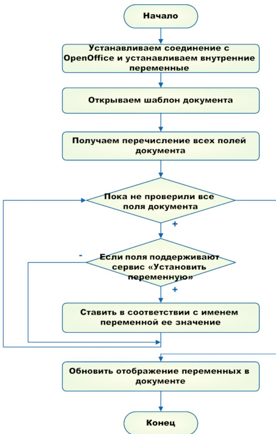
Рис. 1. Блок-схема алгоритма обработки шаблона
