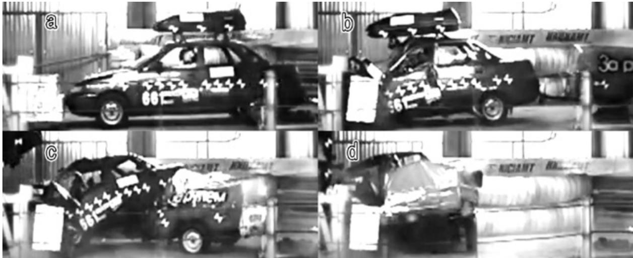
Рис. 1. Фронтальное столкновение автопоезда на базе автомобиля ВАЗ 2110
