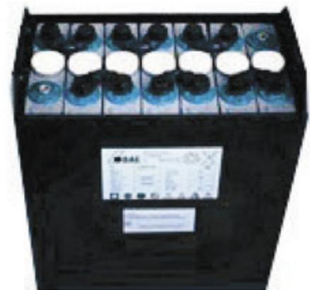
Принимая во внимание актуальность использования современных технологий, пять лет назад был разработан новый аккумулятор 14V2SPzV 120, специально предназначенный для питания поездов, оборудованных шлагбаумами. Такой аккумулятор может быть использован и для сигнальных установок автоблокировки. Он разработан в качестве альтернативы применяемым аккумуляторам ОР и АБН и состоит из семи последовательно соединенных
