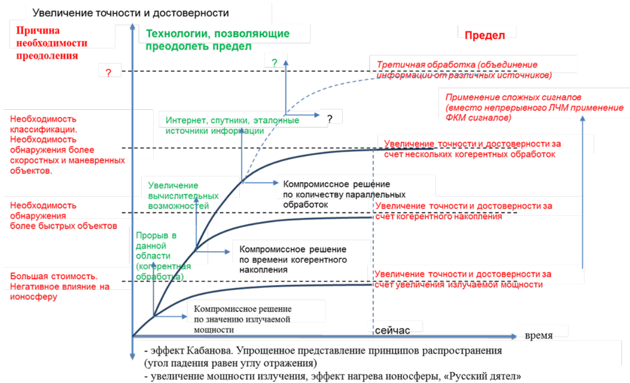
Рис. 5. Результирующая схема развития средств загоризонтного обнаружения
