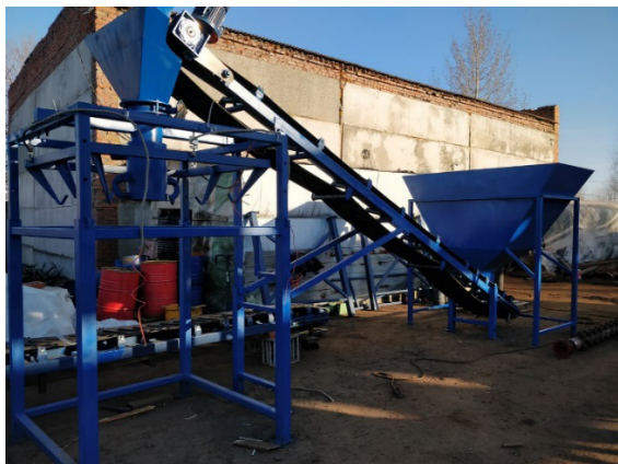
Рис. 3. Затариватель с подачей груза наклонным ленточным конвейером и системой дозирования подаваемого груза
