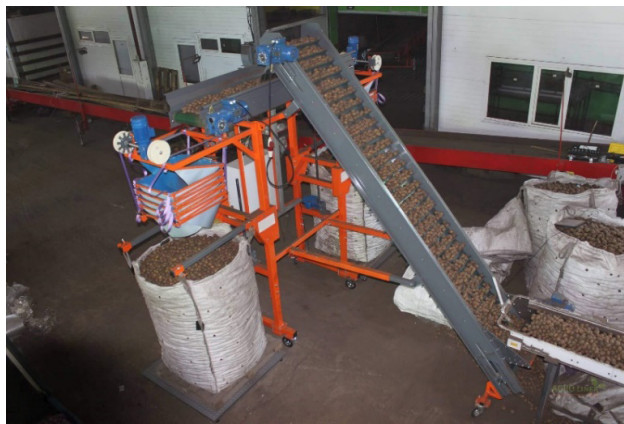
Рис. 4. Затариватель с подачей груза наклонным скребковым конвейером и конвейерным распределителем
