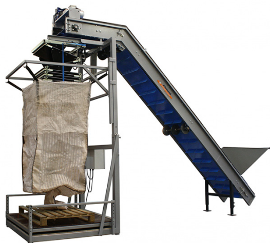
Рис. 5. Затариватель с подачей груза полого-наклонным скребковым конвейером и системой гашения динамических колебаний мешка.
