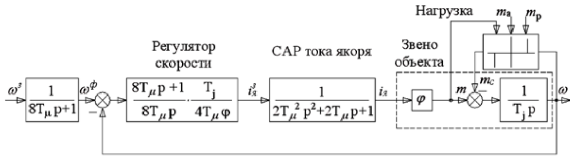
Рис.3. Структурная схема двукратной САР скорости
