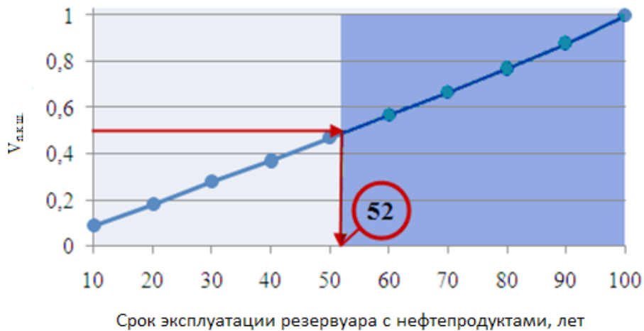
Рис. 1. Зависимость разрушающего воздействия природно-климатических и техногенных факторов от срока эксплуатации резервуаров с нефтепродуктами
