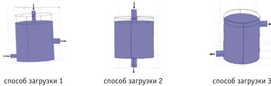
Рис. 1. Расположение входных и выходных труб
