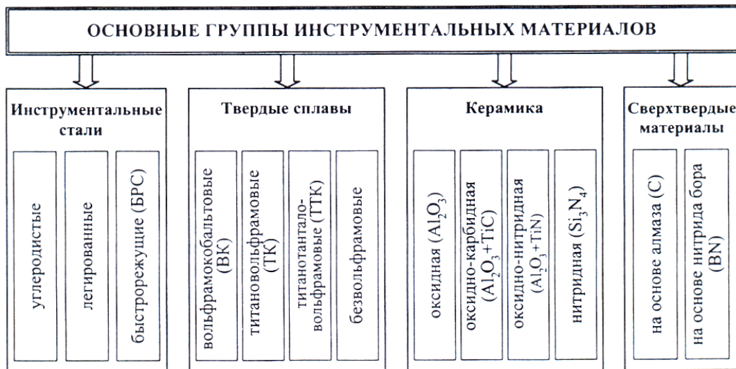
Рис. 2. Система и классификация материалов для режущей части инструмента
