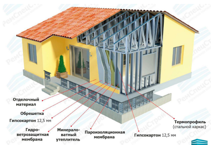
Рис. 1. Схема устройства здания на основе ЛСТК [4]
