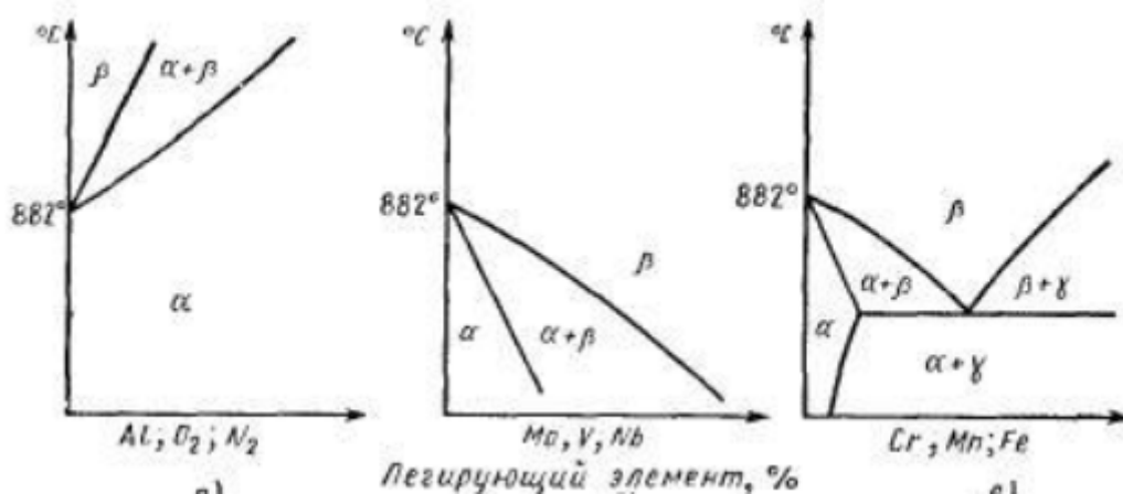
Рис. 1. Схема влияния легирующих элементов и примесей на температуру аллотропического превращения титана
