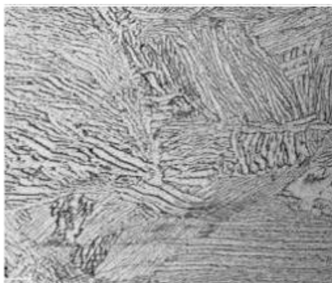
Рис. 2. Характерная микроструктура плит из титанового сплава ПТ-3В
