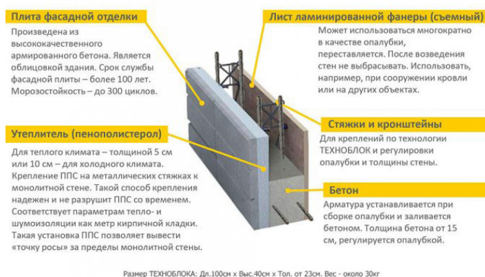
Рис. 3. Схема нсъемной опалубки [3]
