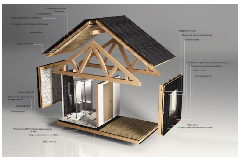
Рис. 4. Устройство каркасно-щитового здания [12]
