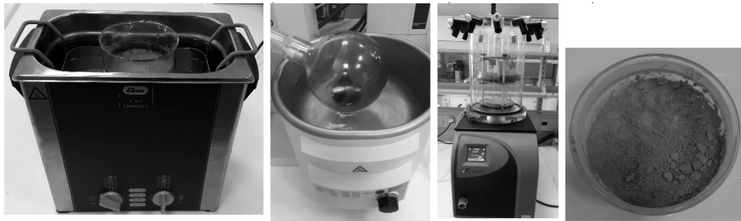
Рис. 1. Слева-направо. Ультразвуковая экстракция; упаривание в роторном испарителе; сушка в лиофилизационной установке; сухой измельченный экстракт верблюжьей колючки
