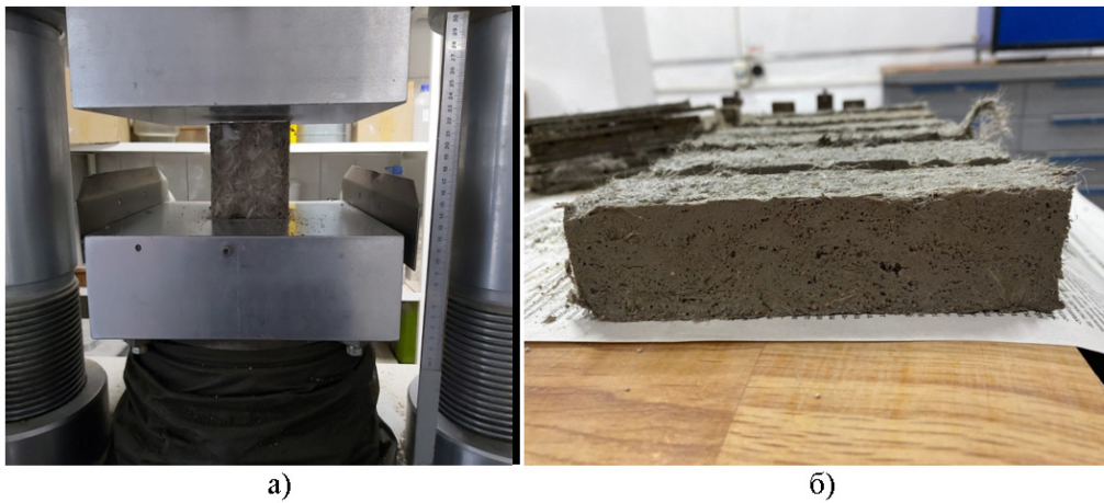
Сурет 1. а) 100x100x100 мм текше пішінді үлгі; б) 40x40x160 мм пішінді үлгі
